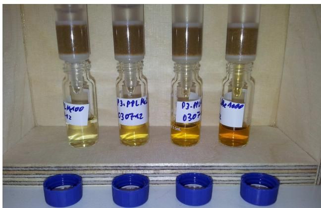
Abb. 8: Elution des SPE-DOMs (Probe P3) von PPL-Kartuschen mit Methanol; sortiert nach ansteigendem Anreicherungs-volumen (von links 100 mL bis rechts 1000 mL).
