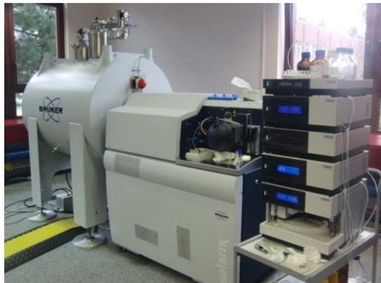
**Abb. 15:** FT-ICR-MS solariX der Firma Bruker Dalton GmbH in Bremen.
