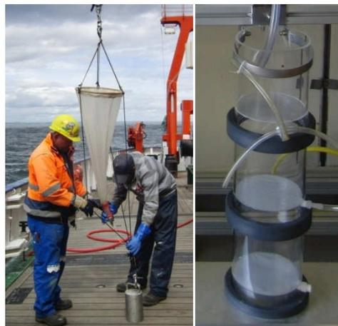
**Abb. 13:** Planktonnetz an Bord der FS Heincke (links); Gazeturm zur Fraktionierung der Planktonproben (rechts).
