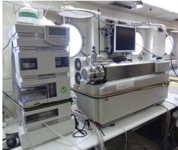
**Abb. 14:** Triple Quadrupole Massenspektrometer 4000 QTRAP® mit LC-Ankopplung an Bord der FS *Heincke*.
