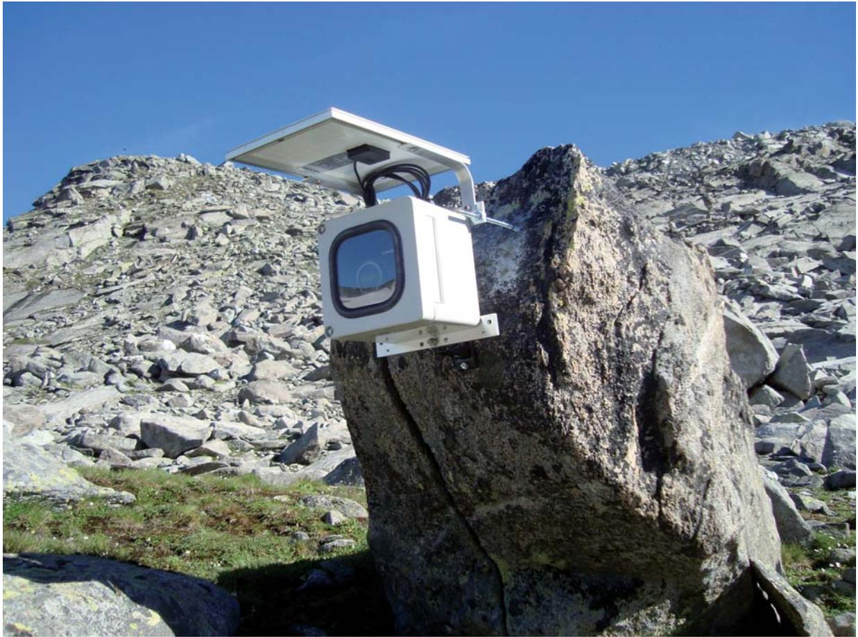
Abbildung A.6: Automatische Kamera
