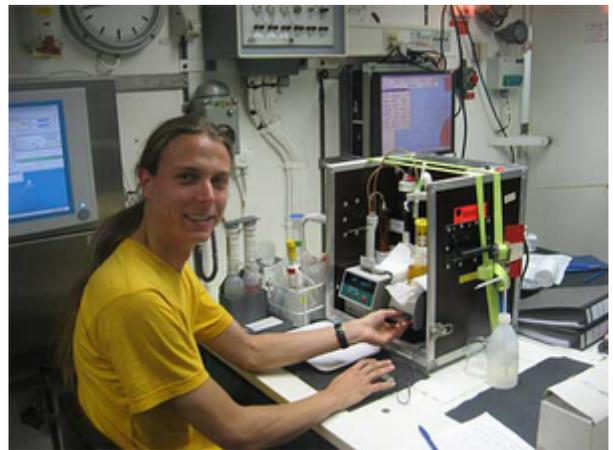
Henry Bittig bestimmt den Sauerstoffgehalt von Wasserproben aus dem Durchfluss-System mittels Winkler-Titration. (Foto: T. Steinhoff)
