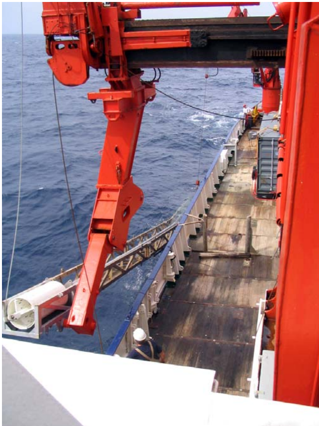
Abb. 2: Aussetzen des Kolbenlotes in der Inner Sea der Malediven.
