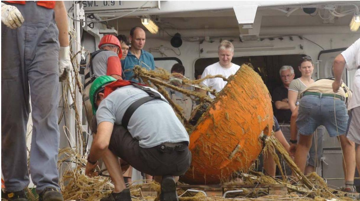
**Abb. 2:** Die obersten Instrumente der TENATSO Verankerung sind dicht an der Oberfläche, was sich hier durch starken Bewuchs und abgerissene Fischerei-Langleinen zeigt.
