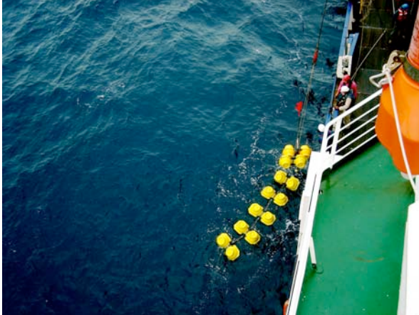
BSH Verankerung FBZ 1 wird geborgen
