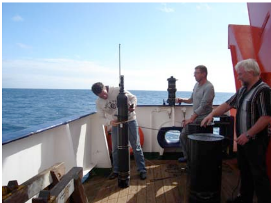
Ein ARGO Float wird steuerbord achtern zur Auslegung vorbereitet (links). Ein XBT wird backbord achtern abgeworfen (rechts)
