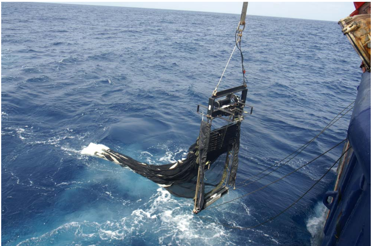
Das MOCNESS-Netz wird am Heck der METEOR ausgesetzt. Foto T. Tanhua.
