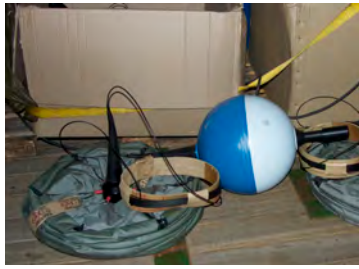
Eine Satellitenboje kurz vor dem Aussetzen.
