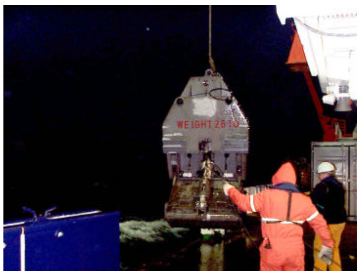
Nächtlicher Einsatz mit dem TV-Greifer.
