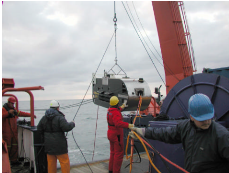
Das neue Sidescan Sonargeräte geht zu Wasser.
