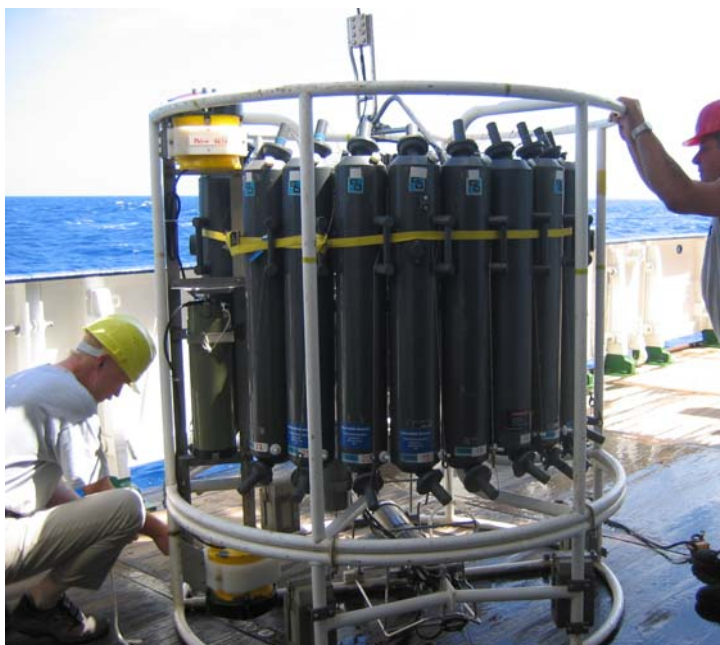
Abb.1 Die ersten CTD/LADCP Stationen. Die beiden LADCPs sind an ihrer gelben Farbe zu erkennen. Dazwischen befindet sich der druckfeste Behälter für die Batterien, die die LADCPs mit Energie versorgen.
