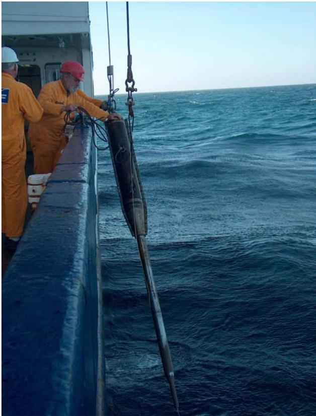
*Abbildung 1 CPT-Messlanze des DFG-Forschungszentrums Ozeanränder Bremen beim Einholen.*
