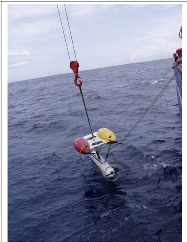
Das Aussetzen und Einholen des AUV ABE wird getestet.
