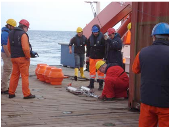
Die Auslegung von Verankerung B23 ist kurz vor dem Ende. Hier werden die akustischen Auslöser angeschäkelt.
