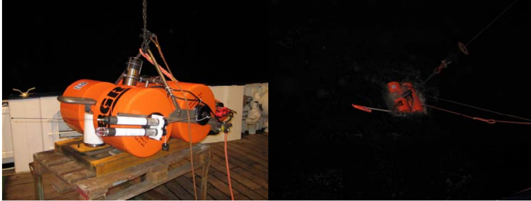
Links: Ozeanbodenseismometer (OBS) vor dem Absetzen. Die orangen Zylinder sind die Auftriebskörper. Im Vordergrund sind Signalsender und Blitzer zu sehen. Unter dem großen weißen Zylinder zwischen den orangen Auftriebskörpern ist das Seismometer befestigt. Rechts: Das OBS wird abgesetzt.
