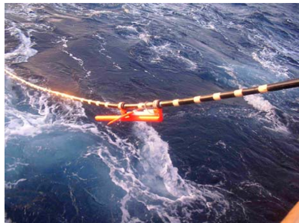
Seismik Streamer (Messkabel) mit Tiefensteuergerät: An dem schwarz-weißen Streamer hängt ein sogenannter „Bird“, der mit seinen Flügeln den Streamer in von uns bestimmte Tiefen lenken kann. Im Allgemeinen schleppen wir den Streamer in 12 Meter Tiefe. In dem schwarz-weißen Streamer (3900 m lang) befinden sich die Hydrophone (Unterwasser-Mikrophone) mit denen wir die Schallwellen aufzeichnen.
