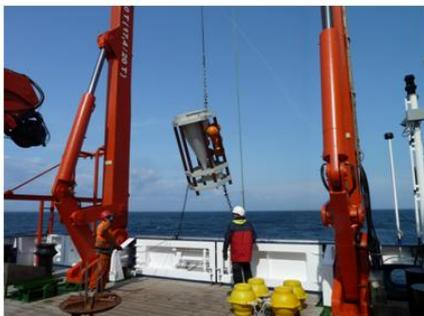
Abb.3 :Auslegung einer Sinkstoffalle im inneren St. Lawrence-Ästuar
