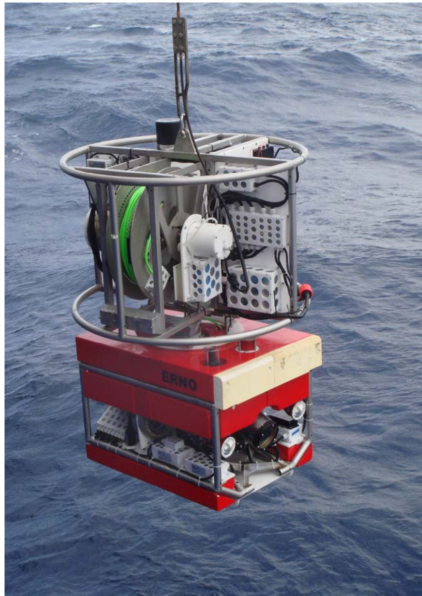
TMS und ROV (ERNO, rot) kurz vor dem Einsatz.
