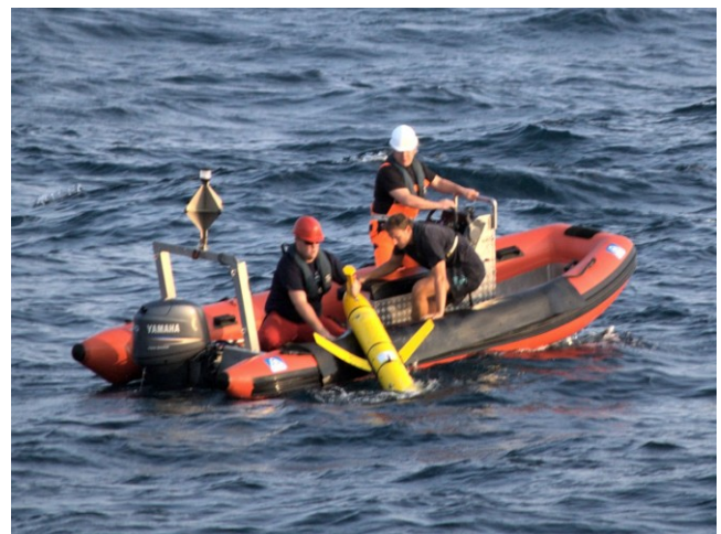
Ein Gleiter des 2. Kieler Gleiterschwarmexperimentes wird an Bord des Schlauchboots der Maria S. Merian gezogen (Foto: Johannes Lampel).
