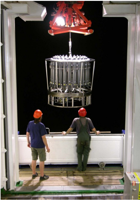
Tropische Nächte: Der Kranzwasserschöpfer verlässt den Hangar, um die Arbeitsgruppen mit Wasserproben aus der Tiefe zu versorgen.
