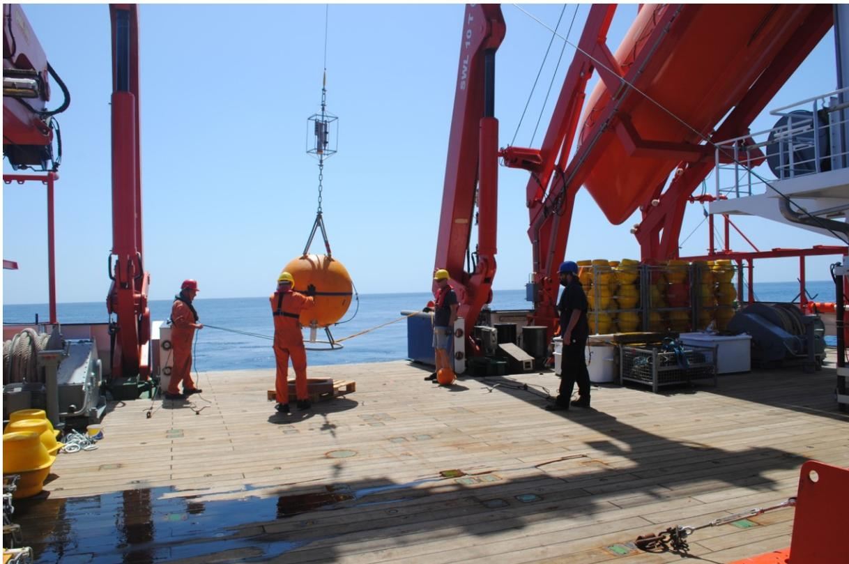
**Abb. 1:** Auslegung des Kopfelements einer Verankerung am südlichen Rand der Sauerstoffminimumzone. Gut zu erkennen ist der Instrumentenkäfig (oberhalb der Auftriebskugel) zum Schutz der Sauerstoff-, Temperatur- und Salzgehaltssensoren. (Photo: Bendix Vogel).
