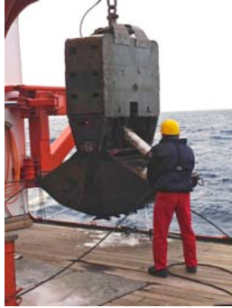
Der TV-Greifer mit offenen Schaufeln vor und geschlossenen Schaufeln und einer Ladung Sediment nach dem Einsatz (Fotos: Kaj Hoernle)
