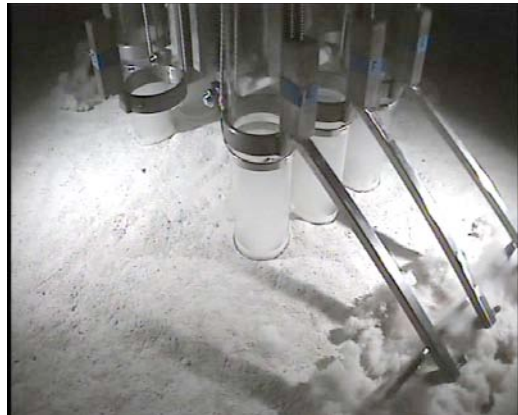
Der Multicorer kurz vor dem Absetzen auf den Meeresboden und beim Zugriff in die Tiefseesedimente.
