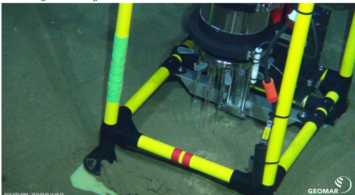
Abb 4. Der Profiler mit Mikrosensoren misst die Atmungsleistung von Mikroorganismen in gestörten Sedimenten am Meeresboden.
