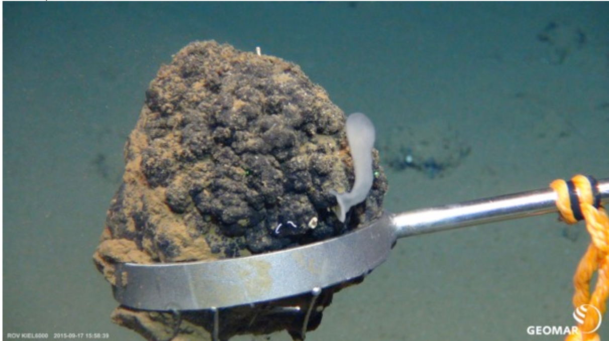
Abb. 5: Eine Manganknolle mit Aufwuchs wird in die Knollen-Kammer verbracht, wo sie mehrere Tage inkubiert wird um Sauerstoffzehrung zu messen. Bildquelle: ROV Kiel 6000, GEOMAR
