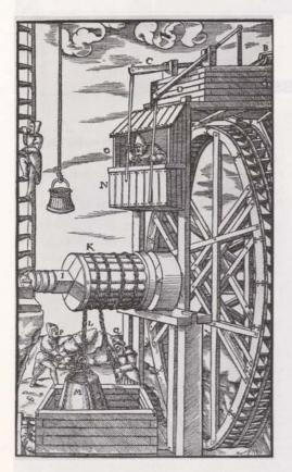
Bild 7: Zwei Schaufelkränze hat das Kehrrad, um die Bulge über eine Holzwelle aufund abzuhaspeln
