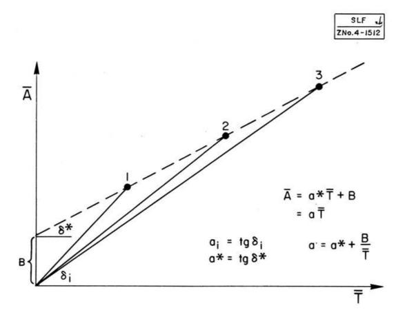
$\frac{Fig.\ 1}{(\bar{A}\ Abfluss\ bzw.\ Ablation,\ \bar{T}\ positive\ Lufttemperatur);\ Abnahme von\ a\ mit\ zunehmender\ Temperatur.}$
