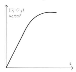
Abb. 8. Allgemeine Darstellung eines Druckversuches (deformationsgesteuert).
