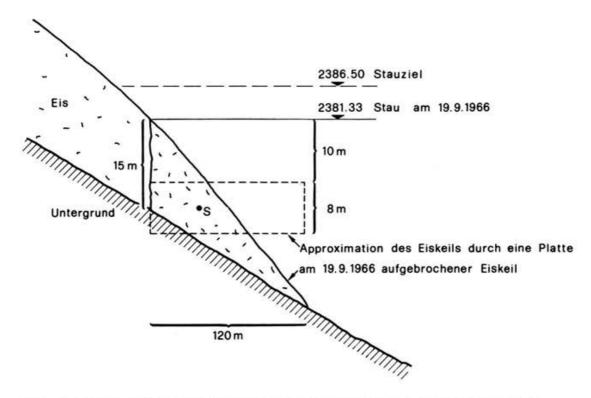
Abb. 6. Längsschnitt (5-fach überhöht) durch die am 19.9.66 aufgebrochenen Eismassen. Für die Nachrechnung wird der Eiskeil durch eine Platte angenähert (----).
