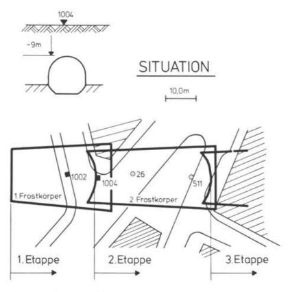
Abb. 15. Situation des Milchbucktunnels mit den beiden ersten Gefrierphasen.
