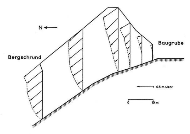
Abb. 7. Querschnitt in etwa nord-südlicher Richtung durch die Gipfelvergletscherung. Auf der Südseite der Krete verläuft die Schnittfläche durch die Bohrlöcher 1 bis 3, auf der Nordseite folgt sie der Richtung des steilsten Oberflächengradienten. Die Pfeile stellen Geschwindigkeitsvektoren dar, deren Betrag einer Zähigkeit des Eises von 5 · 10<sup>14</sup> poise entsprechen würde.
