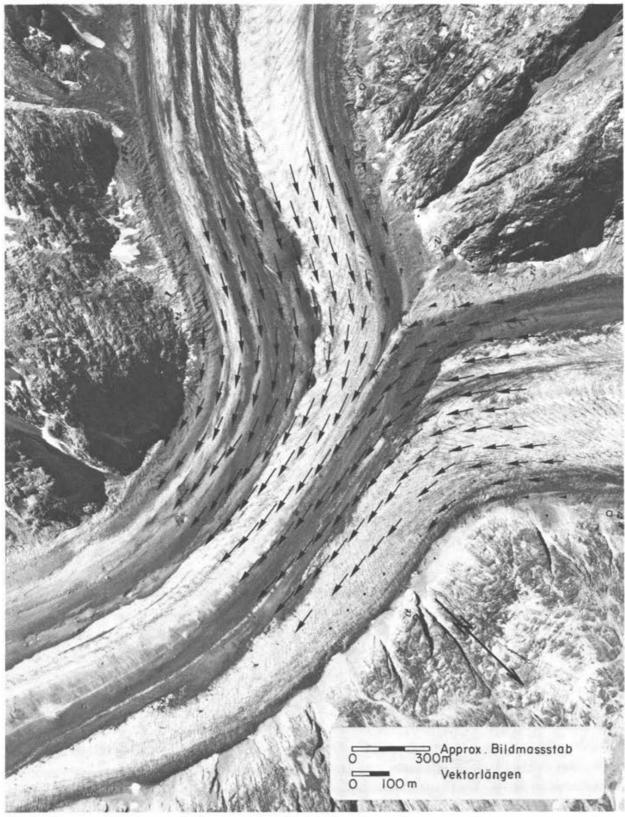
Abb. 1 Zusammenfluss des Finsteraar- und Lauteraargletschers zum Unteraargletscher. - Verschiebungen vom 24.8.1973 bis zum 22.9.1975. Flugaufnahme der Eidg. Vermessungsdirektion vom 22.9.1975.
