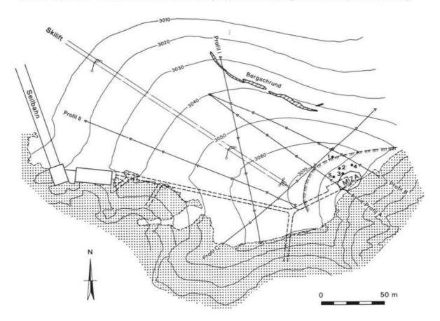
Abb. 2. Situation mit eingezeichneten seismischen Profilen (I, II, A, B, C) und thermischen Eisbohrungen (1 bis 5). Freiliegende Felspartien sind mit einem Punktraster hervorgehoben. MZA = Fernmelde-Mehrzweckanlage der PTT
