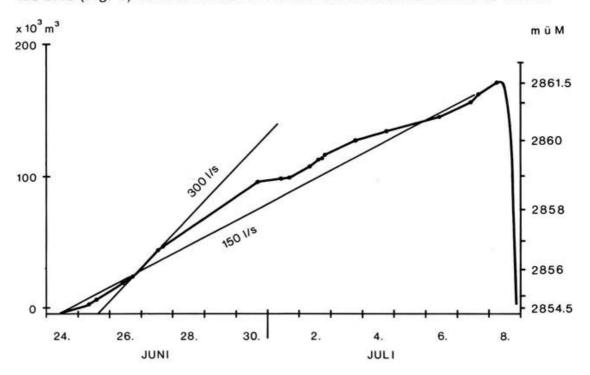
Fig. 3. Stauvolumen (links) resp. Spiegelkote (rechts) von See 3 während des Aufstaus und Seeausbruches von 1970 in Funktion der Zeit mit Linien der maximalen und mittleren Zuflussmenge.
