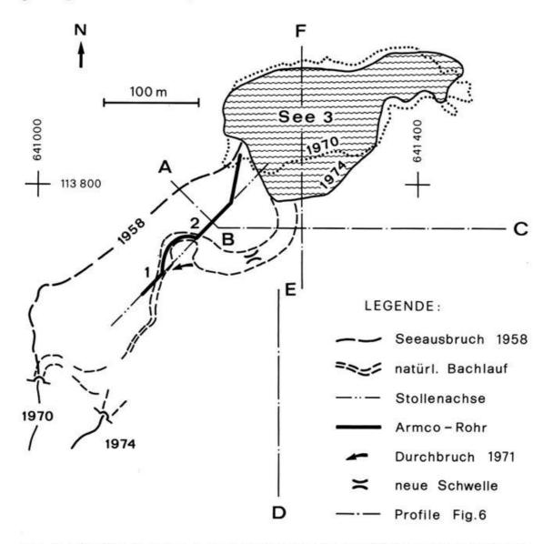
Fig. 5. Planskizze von See 3, dem Eisstollen und den natürlichen und künstlichen Entwässerungsanlagen. 1,2 = Kreuzungsstellen des Eisstollens mit der Bachhöhle; A-C = Längsprofil, D-F = Querprofil (s. Fig. 6).
