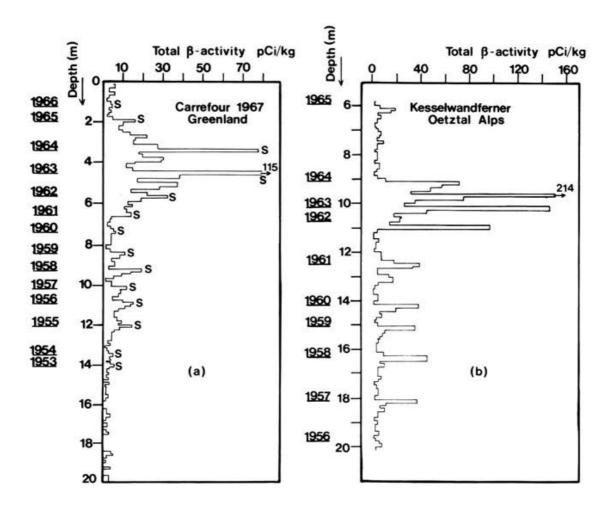
Abb. 2: a) Beispiel für ein Aktivitätsprofil in einem kalten polaren Gletscher: Vertikalprofil der Gesamt- β-Aktivität im Akkumulationsgebiet des Grönländischen Inlandeises (Station Carrefour, 1850 m NN, W. Ambach und W. Dansgaard, 1970). Weitere Profile für die Antarktis sind bei G. Lambert et al., 1977 gegeben.
