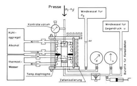
Abb. 2. Triaxialapparat zur Bestimmung der Spannungsänderungen im Boden während dem Eindringen des Frostes.
