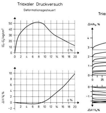
Abb.11. Triaxialer Druckversuch eines Moränenmaterials (deformationsgesteuert), v = 5 mm/Tag
