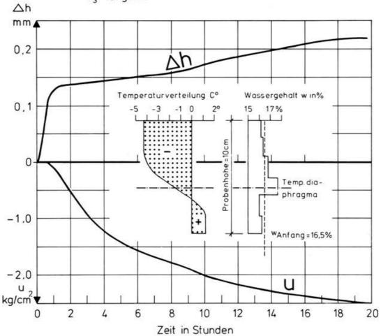
Abb. 3. Frosthebung im Triaxialapparat gemessen unter gleichzeitiger Kontrolle des Unterdruckes respektive des negativen Porenwasserdruckes.  $\sigma 3 = 10 \text{ kg/cm}^2 \text{ und } u_0 = 5 \text{ kg/cm}^2 \text{ als Gegendruck im Porenwassersystem.}$  Temperaturverteilung und Wassergehalt der Probe nach dem Versuch ebenfalls angegeben.
