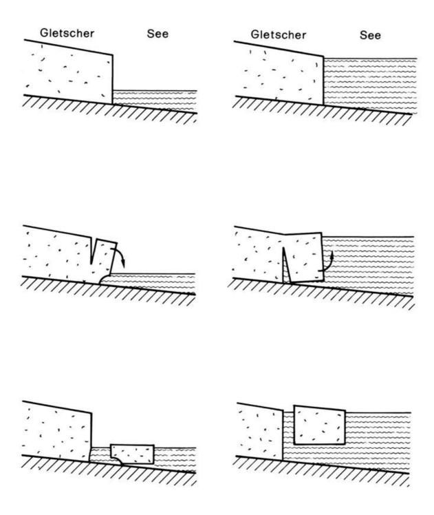
Abb. 1. Entstehung von Kalbungswellen aufgrund von zwei verschiedenen Ursachen: Abbrechende und eintauchende Eismassen im Fall a, aufbrechende und auftauchende Eismassen im Fall b; Darstellung von je drei Phasen.
