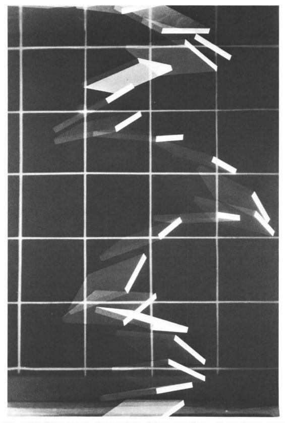
Abb. 7. Bildfolge einer im Wasser frei aufsteigenden Platte mit den Abmessungen 164 x 162 x 14 mm und der Dichte 900 kg/m $^3$ . Die Maschenweite des Rasters beträgt 200 mm und das Blitzintervall 0.6 s.
