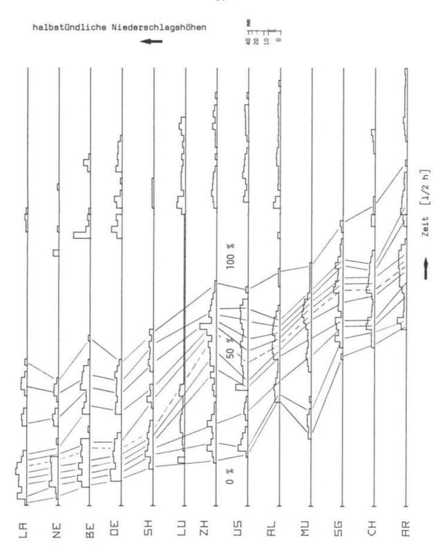
Abb. 1. Beispiel eines Niederschlagsfeldes vom Typ LAUSANNE (LA) (29.8.1966) mit Quantilen 0, 10, 20, ..., 90, 100 %.
