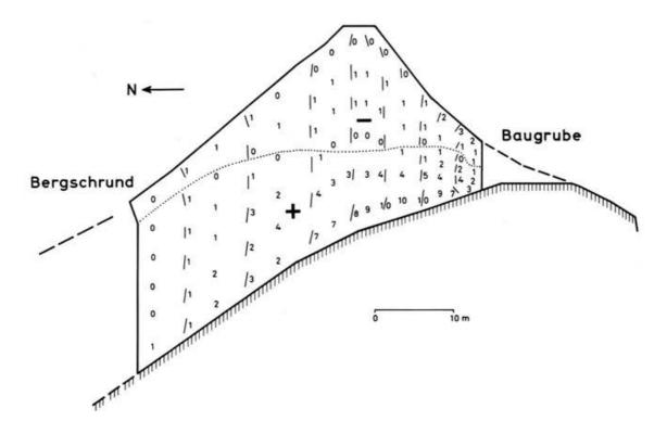
Abb. 8. Gleicher Querschnitt wie Abb. 7. Die Zahlen geben den Betrag der kleinsten Hauptspannung  $\sigma_3$  in  $10^{-1}$  bar an; oberhalb der punktierten Linie ist  $\sigma_3$  negativ (Zugspannung). Die Richtung von  $\sigma_3$  ist senkrecht zu den eingezeichneten Linienelementen.
