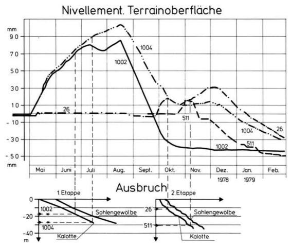
Abb. 16. Hebungsmasse in Abhängigkeit vom Fortschritt im Tunnelaushub für die Kalotte und das Sohlengewölbe. Oben im Bild: der Temperaturverlauf der Kühlsole.
