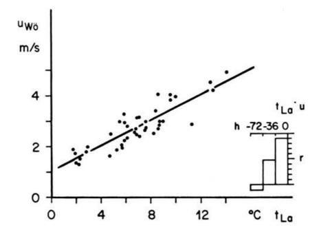
Fig. 6. Zusammenhang zwischen Tagesmittelwerten der Lufttemperatur  $t_{La}$ , gemessen an der Hangstation (2220 m ü.M.) und der an der Zunge des Gr. Aletschgletschers (2185 m ü.M.) gemessenen Windgeschwindigkeit  $u_{w\ddot{o}}$  (Beobachtungsperiode: 18. Juli – 28. August 1965). Rechts in der Figur sind die Korrelationskoeffizienten für eine Zeitverschiebung von 0, -36, bzw. -72 Stunden zwischen  $t_{La}$  und  $u_{w\ddot{o}}$  graphisch angegeben.
