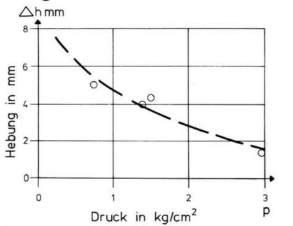
Abb. 5. Kombinierter Versuch aus Hebungsverlauf und Druckentwicklung während des Gefriervorganges. Durchführung in der Frosttruhe bei unterschiedlicher Einspannung
