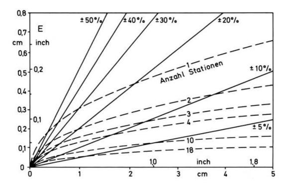
Abb. 4. Bei Gebietsniederschlagsberechnungen verursachter absoluter Fehler ± E und relative Fehler als Funktion der Niederschlagsmenge für ein Gebiet der Fläche A = 563 km² und für 6 unterschiedliche Stationszahlen; nach /27/.
