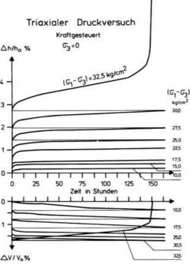
Abb. 12. Triaxialer Druckversuch des gleichen Materials (kraftgesteuert) mit verschiedenen Belastungsstufen.
