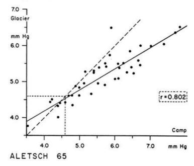
Fig. 4 Beziehung zwischen den Tagesmittelwerten des Dampfdrucks, gemessen an der Hangstation (Camp, 2220 m ü.M.) und an der Gletscherstation (2185 m ü.M.) im Zeitraum 18. Juli - 28. August 1965 (Sättigungsdampfdruck bei 0°C = 4.58 mm Hg bzw. 6.11 mb)
