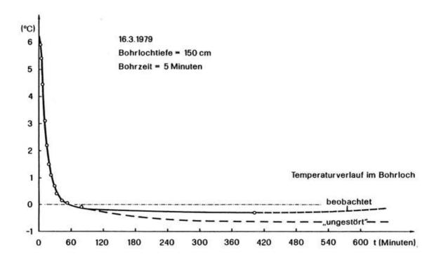
Abb. 4. Bohrloch-Temperaturmessung im Verbindungsstollen
