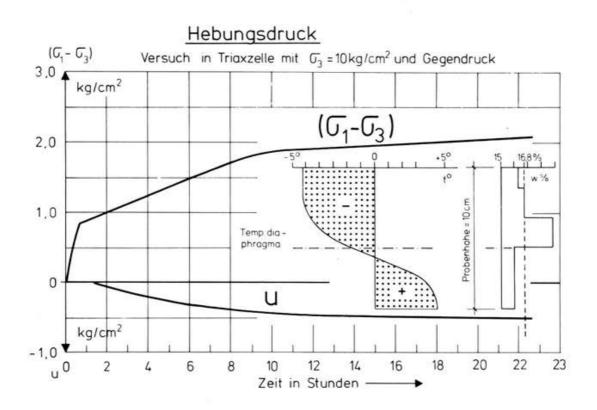
Abb. 4. Hebungsdruck ( $\sigma_1$  -  $\sigma_3$ ) im Triaxialapparat mit der Verteilung des Unterdruckes.  $\sigma_3$  = 10 kg/cm<sup>2</sup> und u<sub>0</sub> = 5 kg/cm<sup>2</sup>.
