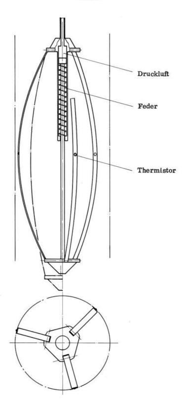
$\frac{\textbf{Fig. 1.}}{\textbf{sonde mit drei Thermistoren}} \, \, \textbf{Schematische Darstellung der Temperatursonde mit drei Thermistoren}$
