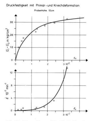
Abb. 13. Versuch aus Abb. 12 als Druckversuch ausgewertet mit Kriechgeschwindigkeit.
