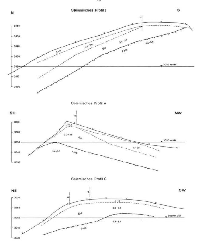
Abb. 3. Drei refraktionsseismische Profile durch die Gipfelvergletscherung. P-Wellen-Geschwindigkeiten in km sec<sup>-1</sup>.
