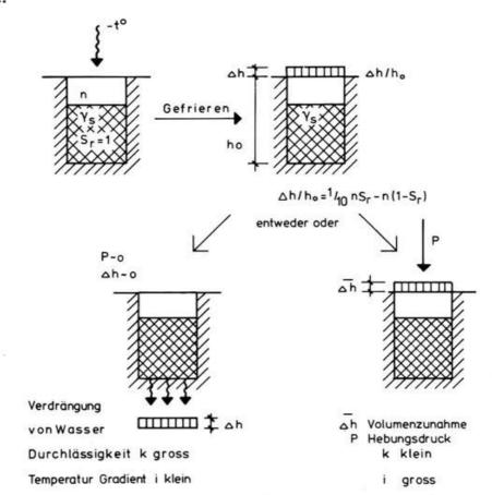
Abb. 1. Schematische Darstellung des Frostvorganges in einem gesättigten Boden. Ohne Drainierung respektive Wassernachschub tritt beim Gefrieren eine Hebung Δh auf. Bei Einspannung ist noch ein Hebungsdruck zu verzeichnen.
