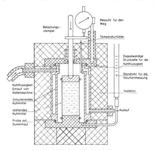
Abb. 10. Schnitt durch die Gefrierzelle.
