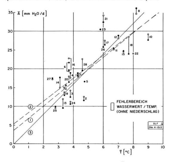
Fig. 2 Mittlere tägliche Ablation (Wasserwertverluste)  $\overline{A}$  der Gesamtschneedecke (Punkte) und der oberen Schichten (Kreise) in Abhängigkeit von der mittleren positiven Lufttemperatur  $\overline{T}$ . Ausgewählte Zeitabschnitte (Nr. gemäss Tabelle 1). Versuchsfeld Weissfluhjoch/Davos (2540 m). Regressionsgeraden 1 und 2 für Punkte, bzw. Kreise. Gerade 3 durch den Nullpunkt  $\overline{A}=a\,\overline{T}$ .
