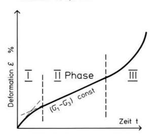
Abb. 9. Druckversuch (kraftgesteuert).
