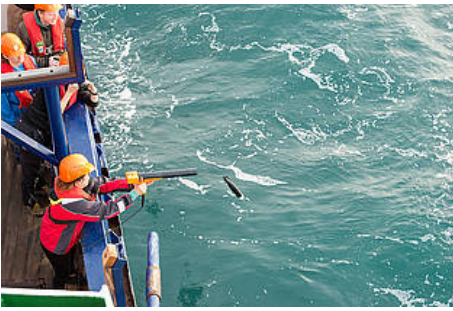
Abb.2: Die erste Messung vom fahrenden Schiff aus. Ein XBT geht zu Wasser. Foto: Michael Ginzburg, AWI (Foto: Alfred Wegener Institut)
