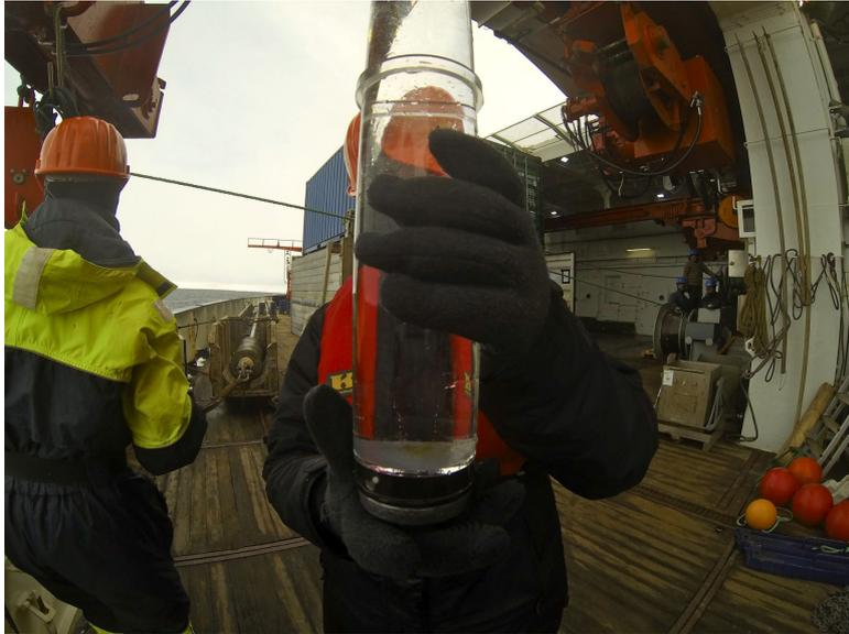
Abb. 1.5: Blick auf eine Sedimentfalle, die in 90 m Wassertiefe verankert war. Auf dem Boden des Gefäßes sind die herab gesunkenen Partikel zu erkennen (@SChristine Dybwad)
