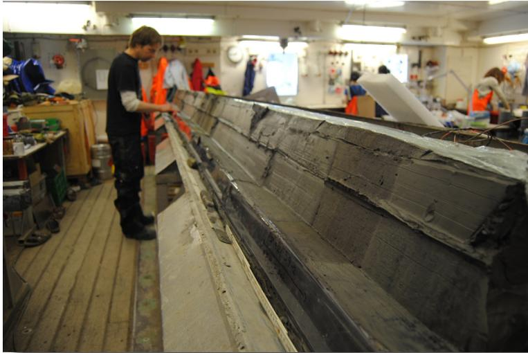
*Abb. 1.7: Das geöffnete Kastenlot nach der ersten Probennahme (@ Kirstin Werner)*
