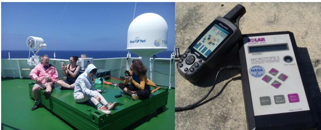
**Abb 3** MICROTUPS Messungen auf dem Peildeck (Foto: T. Mieslinger), Microtops/GPS von NASA's Marine Aerosol Network
