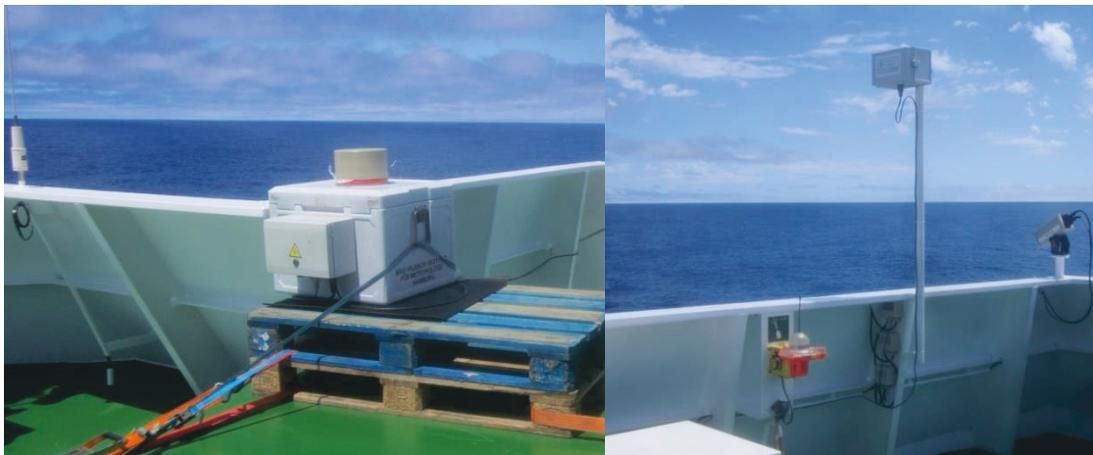
**Abb.6** Die beiden installierten Wolkenkameranysteme des MPI-M auf der Maria S. Merian. Die ältere Kamera im Kühlbehälter (links) und die neuere kleinere (Vogelkasten-) Kamera (rechts).
