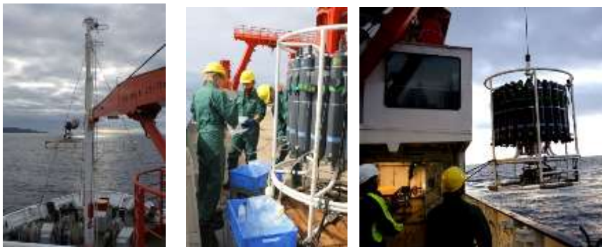
Abbildung 1: Ausfahrt aus Ponta Delgada und Probenentnahme großvolumiger Wasserproben mittels der CTD Rosette
