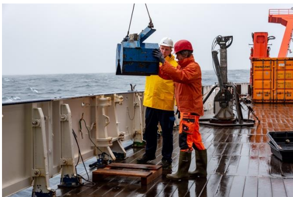
Der Backengreifer ist das meist verwendete Gerät an Bord der METEOR während der ersten Woche der ATHENA Ausfahrt.
