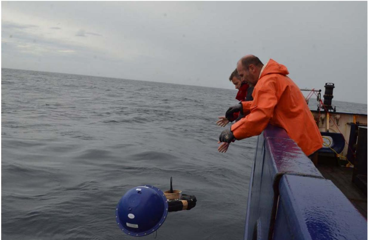
Abb. 2: Aussetzen einer Driftboje (SVP drifter, MetOcean). *Foto: J. Siemssen*
