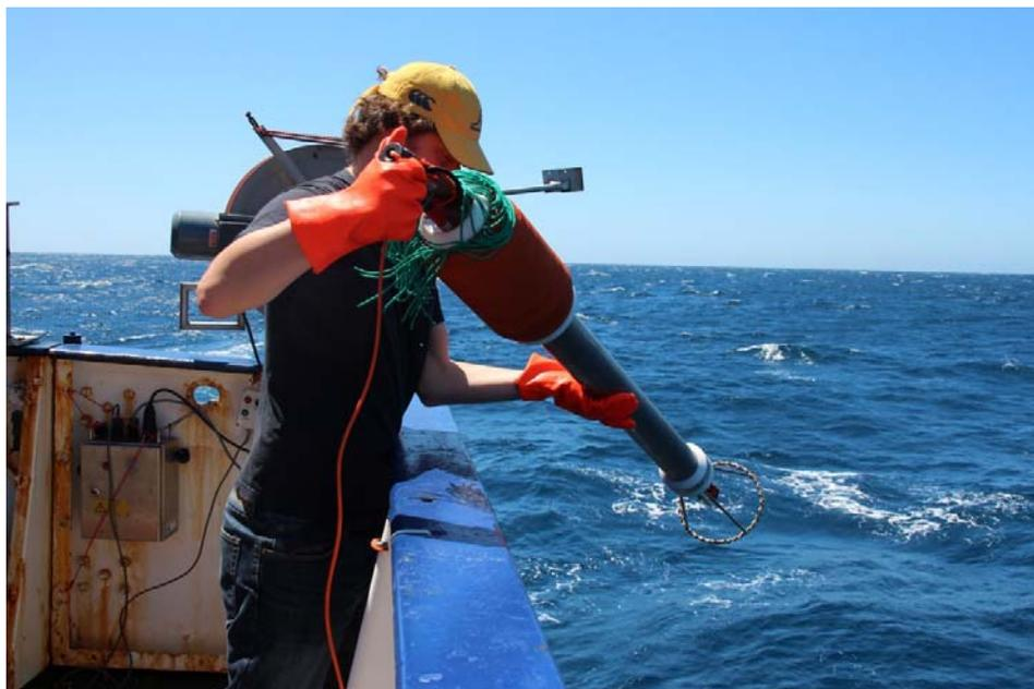
Abb. 1: Aussetzen der Mikrostruktursonde. Foto: T. Wasilewski
