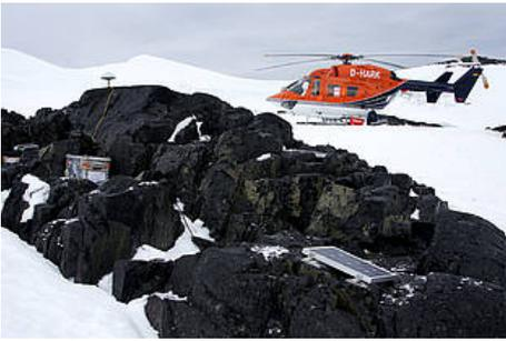
Abb. 2: Eine geodätische GPS-Messstation auf der Clark-Insel, die von Mirko Scheinert und Benjamin Ebermann installiert wurde (Foto: Mirko Scheinert)
