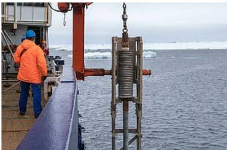
Abb. 1: Das Schwerelot geht ins Wasser, um für eine Sedimentbeprobung mehrere Meter tief in den Meeresboden einzudringen (Foto: T. Ronge)
