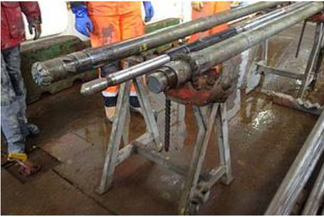
Abb. 4: MeBo-Bohrgestänge mit Bohrkronen links im (Foto: Karsten Gohl)
