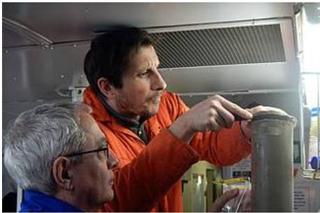
Abb. 3: James und Werner schneiden Scheiben von Meeressediment zur weiteren Untersuchung aus einem Rohr des Multi-Corer (Foto: Alfred-Wegener-Institut)
