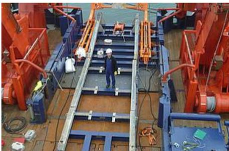
Abb. 1: Montage des Absatzgestells des MeBo auf dem
