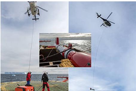
Abb. 1: Die Helikopter-Magnetometersonde zur Vermessung der Erdmagnetfeldes im Einsatz (Foto: T. Ronge)
