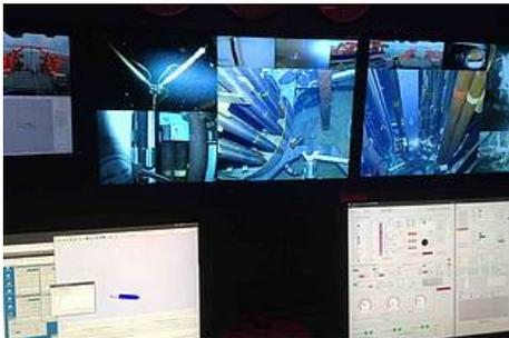
Abb. 3: Im Kontrollcontainer steuern und überwachen die Piloten mit Hilfe von Kameras den Bohrvorgang am Meeresboden (Foto: Karsten Gohl)
