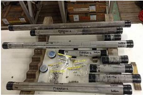
Abb. 1: Ausbeute von Bohrkernen aus bis zu 30 m Tiefe. Erst nach der Vermessung von physikalischen Eigenschaften der Bohrkern in der Kernmessbank werden die Kerne in zwei Hälften gesägt (Foto: Karsten Gohl)
