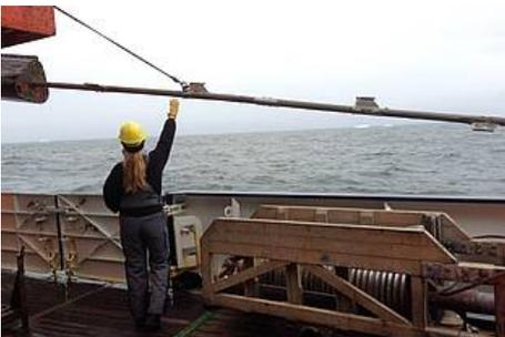
Abb. 6: Ricardas Wärmelanze kommt wieder ans Deck zurück, nachdem die kleinen Temperatursensoren die Temperaturen in verschiedenen Tiefen im Sediment für die Bestimmung des geothermischen Wärmestroms gemessen haben (Foto: K. Gohl)
