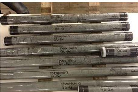
Abb. 2: MeBo-Bohrkerne mit verschiedenen Lagen konsolidierten Sediments. Die in den Plastikrohren befindlichen Kerne werden erst später in zwei Hälften geteilt, um die Sedimente zu beproben (Foto: K. Gohl)
