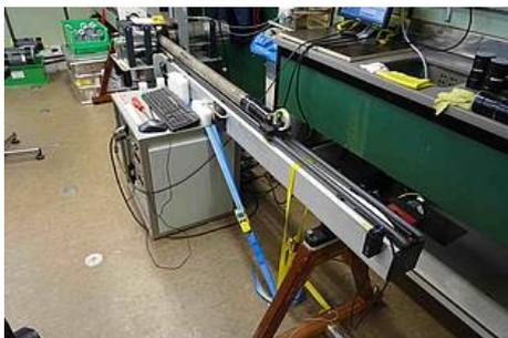
Abb. 3: Vor dem Splitten gehen die MeBo-Bohrkerne erst durch die Multi-Sensor-Kernmessbank, um die physikalischen Eigenschaften zu messen (Foto: T. Frederichs)
