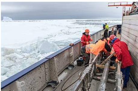
Abb. 2: Das Geologen-Team zieht das Innenkernrohr mit den Sedimenten aus dem Schwerelot (Foto: T. Ronge)
