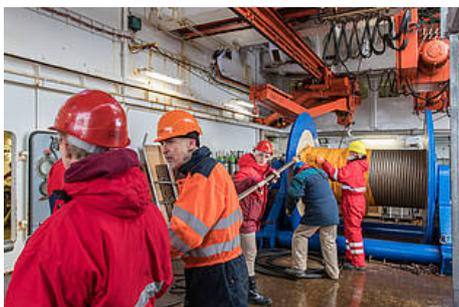
Abb. 4: Der 600 m lange seismische Streamer wird ausgebracht (Foto: T. Ronge)
