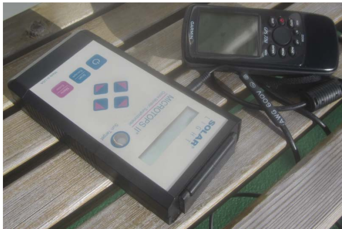
Abbildung 1. das MICROTOPS Sonnenphotometer mit einem GPS (links) die Wolkenbeobachtungsbox (rechts) mit einer normalen Bildkamera (mit Froschaugenblick) und mit einem thermischen Sensor
