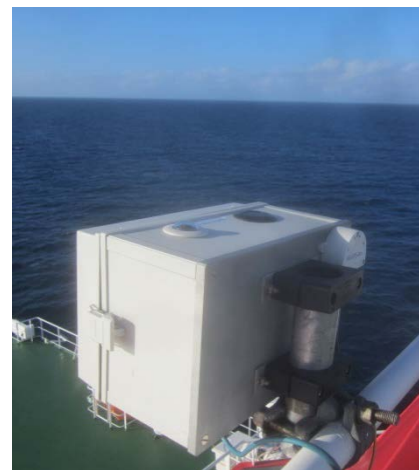
Abbildung 1. das MICROTOPS Sonnenphotometer mit einem GPS (links) die Wolkenbeobachtungsbox (rechts) mit einer normalen Bildkamera (mit Froschaugenblick) und mit einem thermischen Sensor
