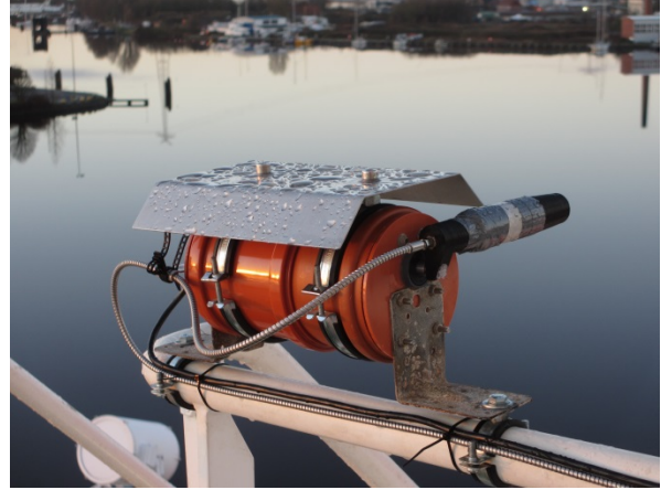
Abbildung 2. MAX-DOAS Geräte des KNMI (left) und des MPI-Luftchemie (right). Beide Instrumente messen die Streustrahlung der Sonne bei verschiedenen Winkeln zum Horizont und dann bei bestimmten Wellenlängen mit und ohne Absorption, um so Säulenwerte und bodennahe Profile von Spurengasen und Aerosolen herzuleiten.
