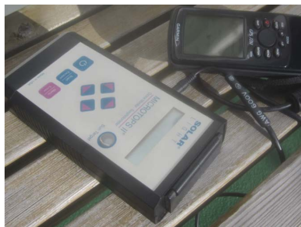
Abbildung1. Die MPI-Met Wolken-Kamera (links) mit zwei Sensoren, einem Froschauge für die Gesamtbedeckung (hinten) und einer geeichten Wärme-Kamera für Wolkenuntergrenzen (vorne). Das Sonnen-Photometer mit einem GPS (rechts) leitet aus Verringerungen der direkten Sonnenstrahlung durch die Atmosphäre (Säulen-) Eigenschaften von Aerosol und Wasserdampf ab.
