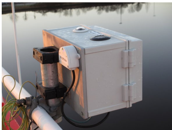
Abbildung1. Die MPI-Met Wolken-Kamera (links) mit zwei Sensoren, einem Froschauge für die Gesamtbedeckung (hinten) und einer geeichten Wärme-Kamera für Wolkenuntergrenzen (vorne). Das Sonnen-Photometer mit einem GPS (rechts) leitet aus Verringerungen der direkten Sonnenstrahlung durch die Atmosphäre (Säulen-) Eigenschaften von Aerosol und Wasserdampf ab.
